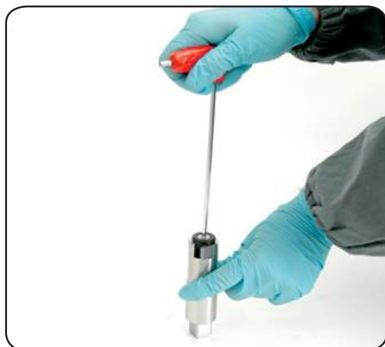
Unscrew the screw n°10 and remove the washer n°9 ( \approx 4\text{Nm}/35\text{ in-lb} )
