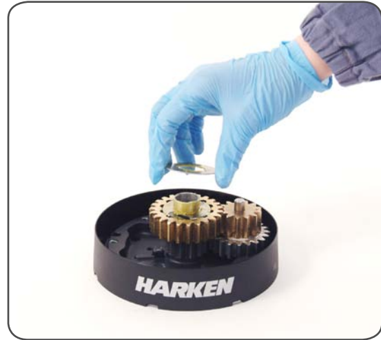
9. Remove the washer n°12
