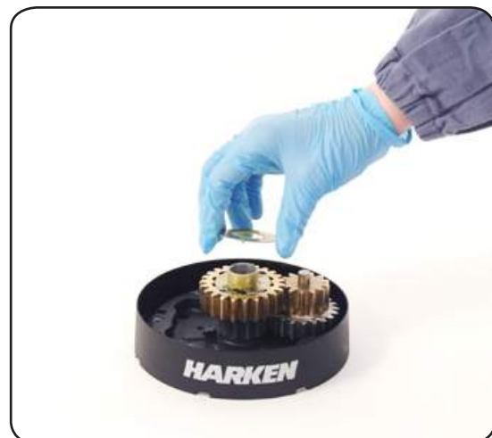
11. Remove the washer n°12
