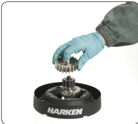
10. Remove the gearing n°10 and remove the pawls n° 7
