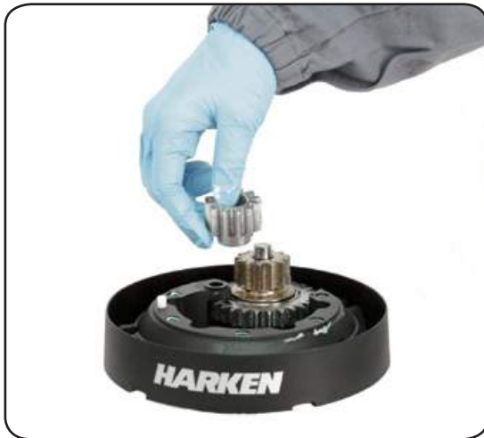
13. Remove the gear n°3
