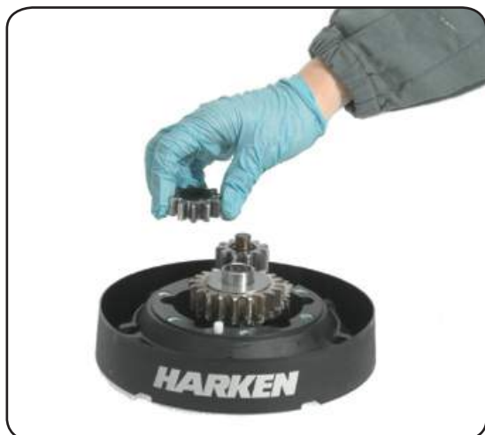
10. Remove the gear n°15
