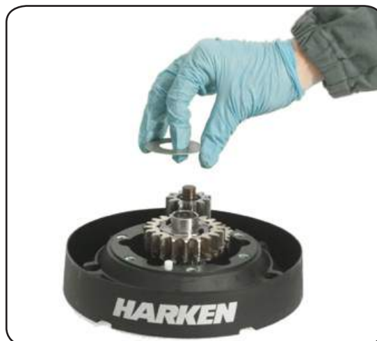
11. Remove the washer n°14
